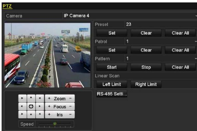
Figura 4-8 Configuración PTZ
