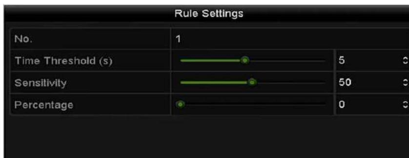
Figura 9-7 Establecer las reglas de detección de intrusión
