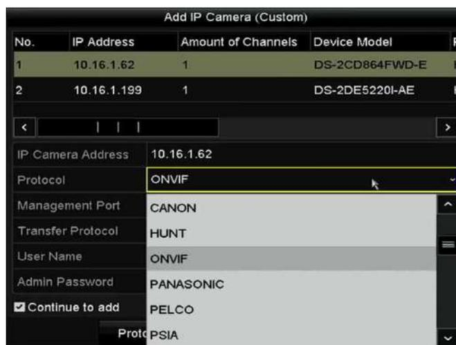
Figura 2-38 Configuración del protocolo
