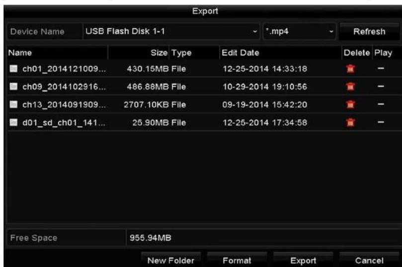
Figura 7-7 Exportar mediante búsqueda normal de vídeo usando un lápiz de memoria USB
