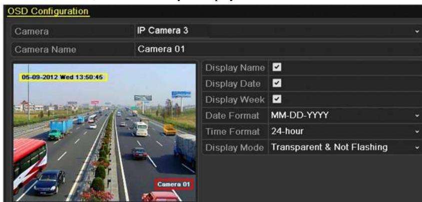
Figura 13-1 Interfaz de configuración de la OSD
