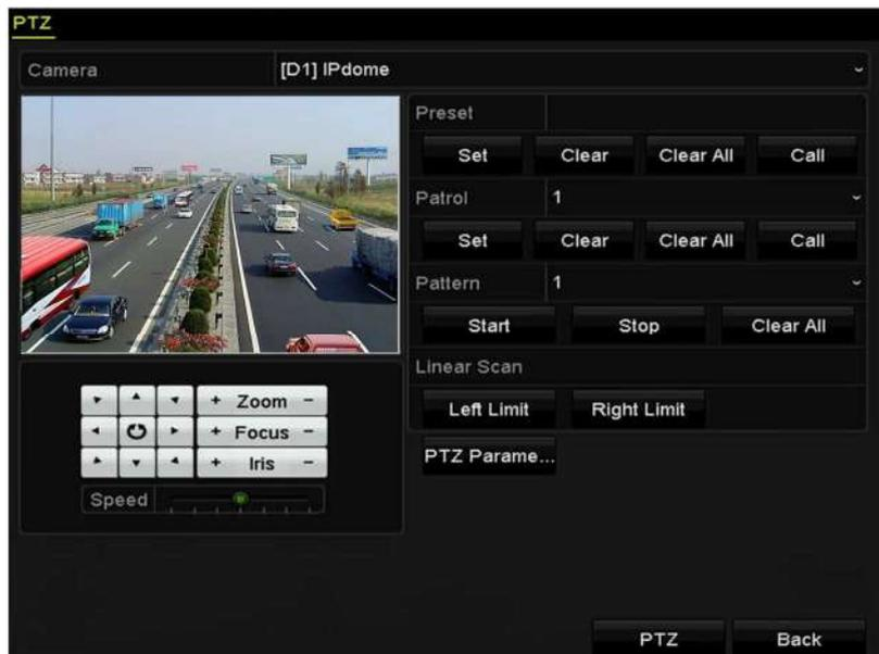
Figura 4-1 Configuración PTZ
